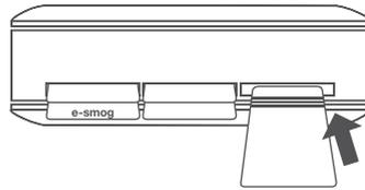
Nehmen Sie das Gerät aus der Verpackung und legen Sie es auf einen sauberen und ebenen Untergrund, so dass es stabil steht. Packen Sie den sinus Converter «e-smog» aus. Stecken Sie den sinus Converter auf der Vorderseite des Gerätes gerade in die dafür vorgesehene Öffnung, bis an den Anschlag. Wichtig: Der sinus Converter muss mit den drei goldenen Streifen nach oben in das Gerät gesteckt werden. Haben Sie den
