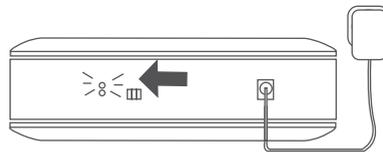
Nehmen Sie das Netzteil und stecken Sie das eine Ende in die Rückseite des Room-Converter Plus und das andere Ende in die Steckdose. Sobald der Room-Converter Plus am Strom angeschlossen ist, ist er aktiviert. Angezeigt wird das durch ein grünes Licht auf der Rückseite des Gehäuses.
